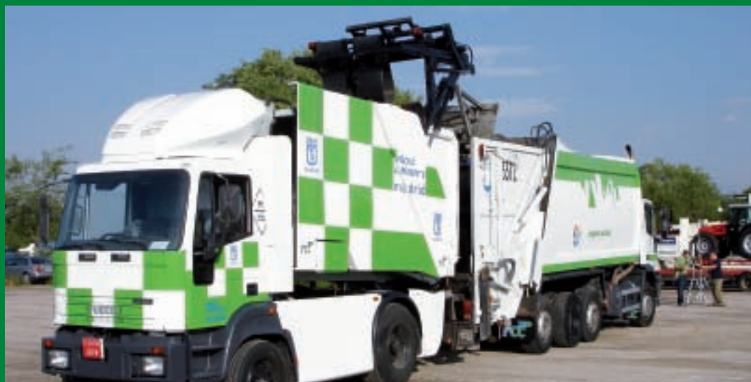
Vehículo recolector-compactor híbrido
